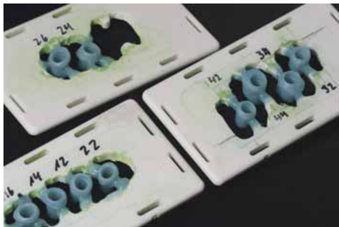
Abb. 56 Die Abutmentprototypen wurden der Angulation entsprechend in einen Übertragungsrahmen geklebt, sodass sie mit einer Kopierfräse in Zirkoniumdioxid umgesetzt werden konnten
