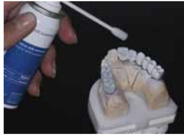
Abb. 19 und 20 Die Anzeichnungen sollten vorgenommen werden, bevor die Wachsmodellation mit Scanspray besprüht wird. Das Scanspray mattiert die Oberfläche und verhindert, dass Reflexionen das Scanergebnis beeinträchtigen
