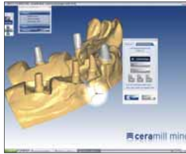
Abb. 49 und 50 Der Streifenlichtscanner hat alle relevanten Bereiche erfasst. Die Software legt die Präparationsgrenzen automatisch per Mausklick fest. Der Vorschlag kann kontrolliert und gegebenenfalls manuell korrigiert werden
