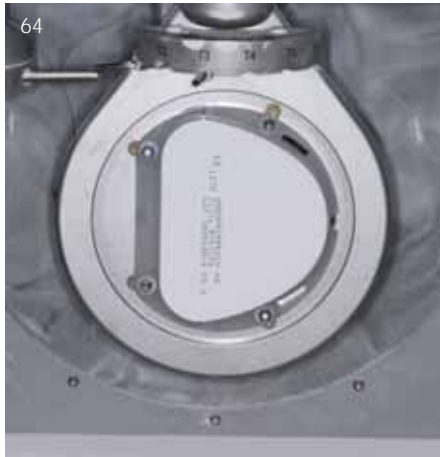
Abb. 64 Der adäquate Rohling (hier Zirkoniumdioxid) wird in die Fräseinheit eingebracht
