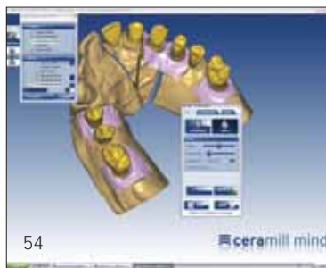
Abb. 54 bis 56 Die virtuelle Konstruktion entspricht exakt der Form, Funktion und Ästhetik des Wax-ups. Per Mausklick lässt man die digitale Konstruktion nun auf die, die Verblendkeramik unterstützenden Gerüste „schrumpfen“
