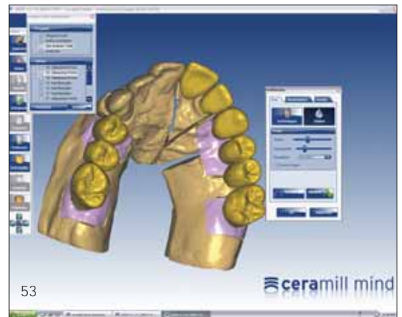
Abb. 51 Im nächsten Arbeitsschritt werden die einzelnen Scans in Deckung gebracht (gematcht)
