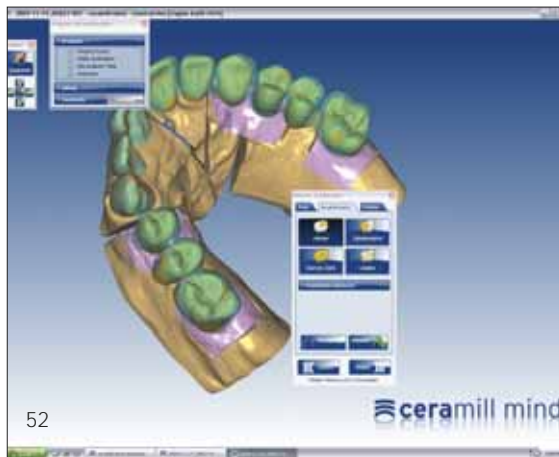
Abb. 49 und 50 Der Streifenlichtscanner hat alle relevanten Bereiche erfasst. Die Software legt die Präparationsgrenzen automatisch per Mausklick fest. Der Vorschlag kann kontrolliert und gegebenenfalls manuell korrigiert werden
