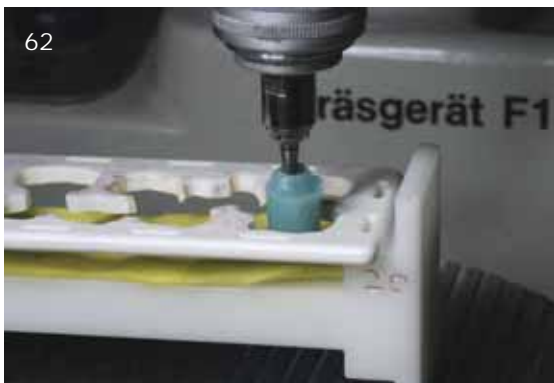
Abb. 62 und 63 Um uns Zeit beim Fräsen zu sparen, bringen wir die Kunststoffteile mithilfe des Fräsgeräts, das wir wie ein Parallelometer nutzen, in die Nullposition. Somit müssen wir den Tisch des Kopierfräasers nur dann kippen, wenn wir die Außenflächen fräsen – die schwierig zu fräsenden Innenflächen der Primärteile sind parallel ausgerichtet. Der mittlere Blank wurde in der Höhe maximal ausgenutzt
