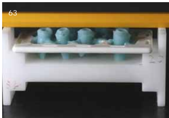
Abb. 62 und 63 Um uns Zeit beim Fräsen zu sparen, bringen wir die Kunststoffteile mithilfe des Fräsgeräts, das wir wie ein Parallelometer nutzen, in die Nullposition. Somit müssen wir den Tisch des Kopierfräasers nur dann kippen, wenn wir die Außenflächen fräsen – die schwierig zu fräsenden Innenflächen der Primärteile sind parallel ausgerichtet. Der mittlere Blank wurde in der Höhe maximal ausgenutzt
